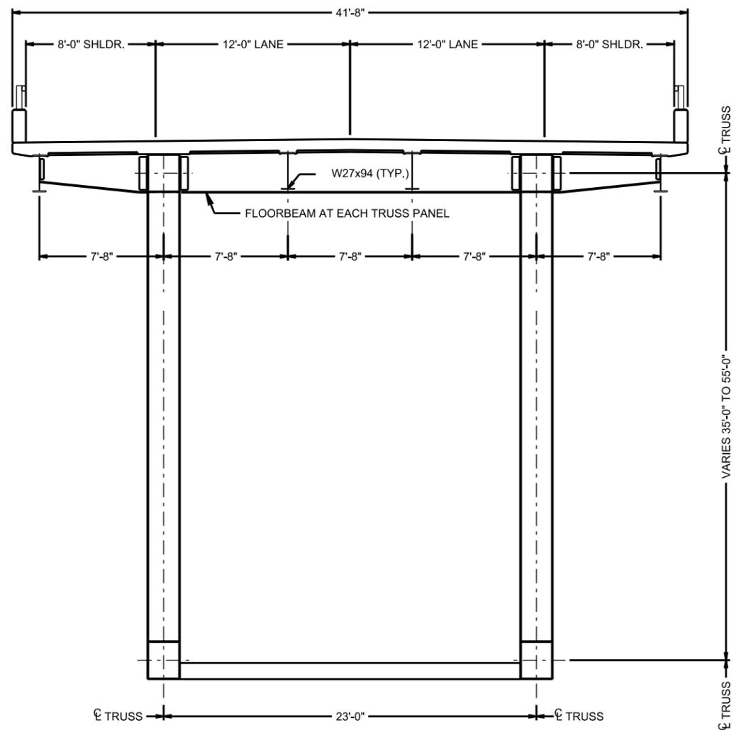
TYPICAL SECTION - DECK TRUSS APPROACH UNITS
