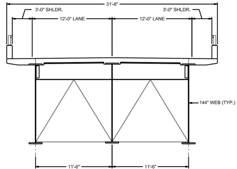
TYPICAL SECTION - STEEL PLATE GIRDER APPROACH UNITS
