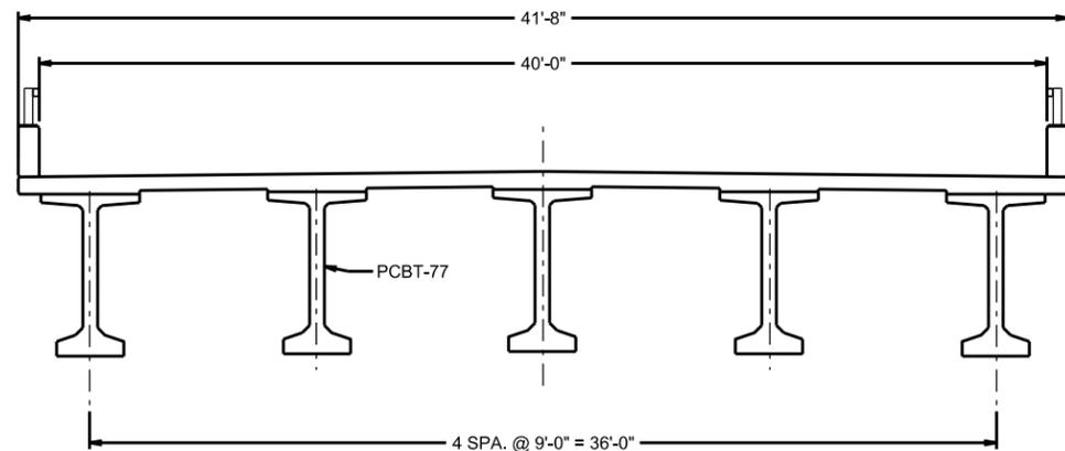
TYPICAL SECTION - BEAM & GIRDER UNITS
