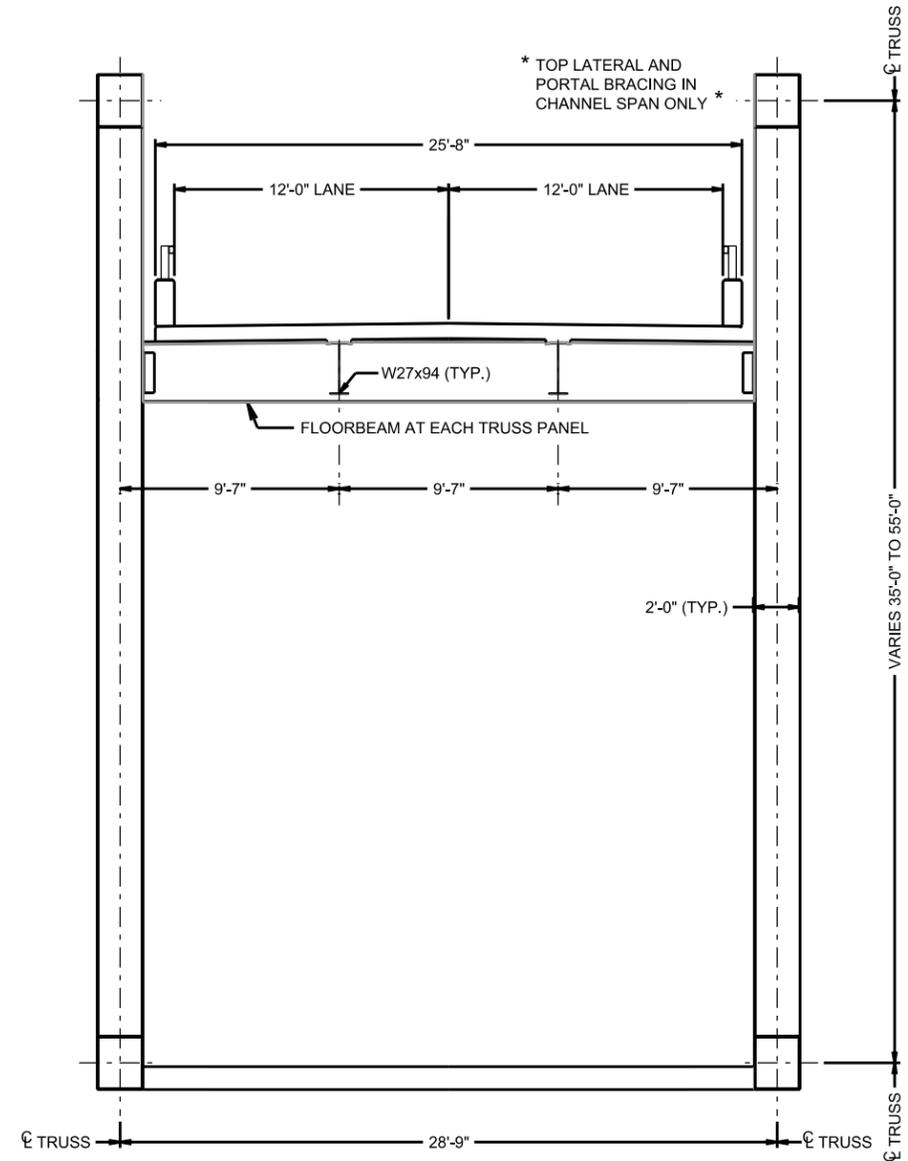
TYPICAL SECTION - THRU TRUSS CHANNEL UNIT
