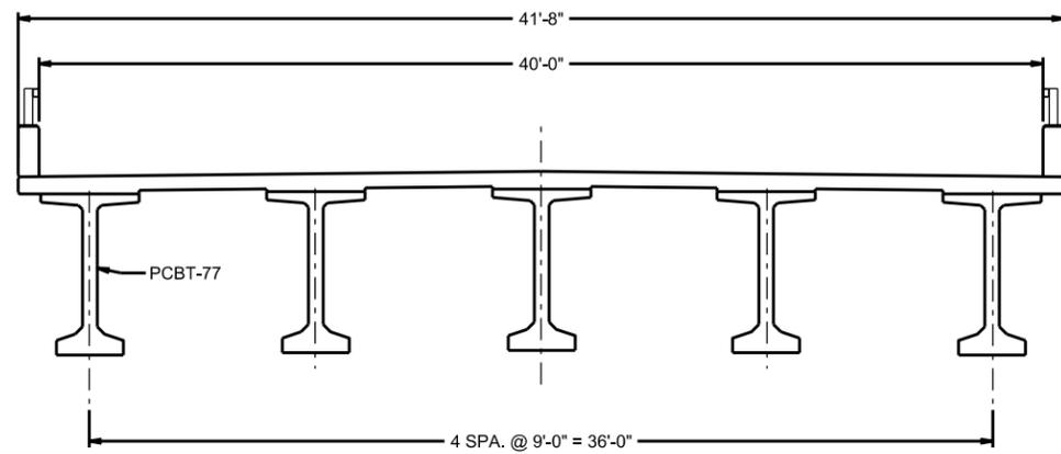
TYPICAL SECTION - BEAM & GIRDER UNITS
