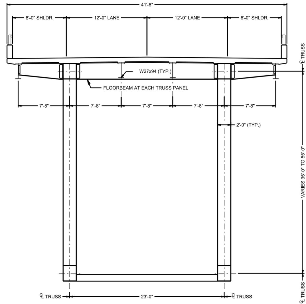
TYPICAL SECTION - DECK TRUSS
