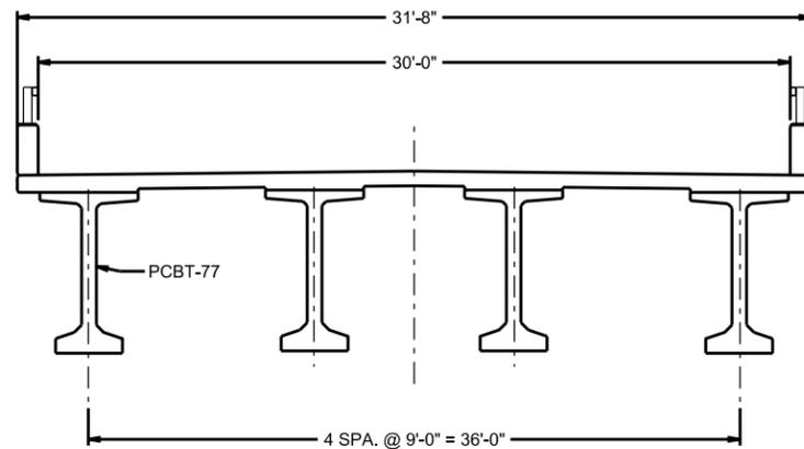
TYPICAL SECTION - BEAM & GIRDER UNITS
