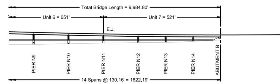
ELEVATION - PIER N9 THRU ABUTMENT B
