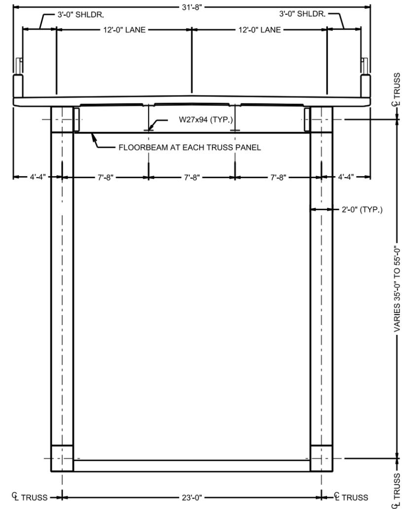
TYPICAL SECTION - DECK TRUSS
