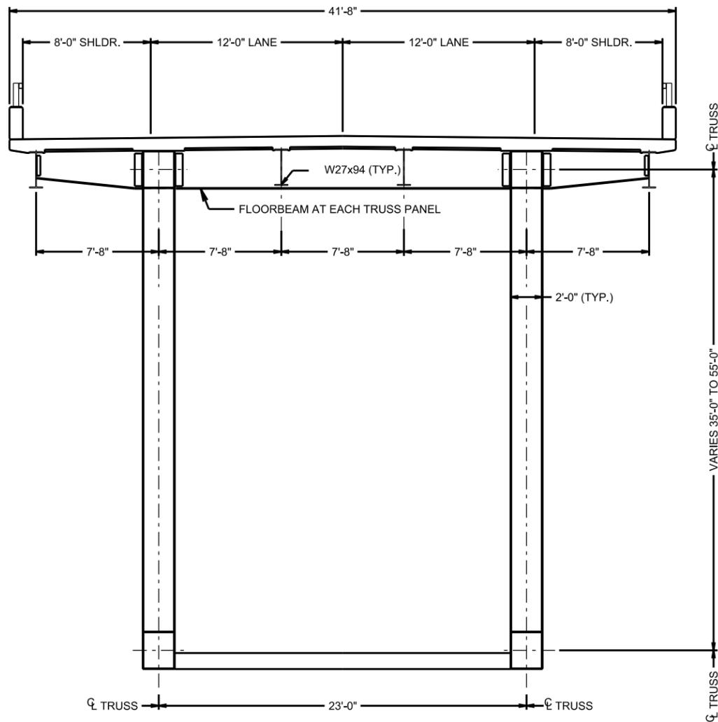
TYPICAL SECTION - DECK TRUSS APPROACH UNITS
