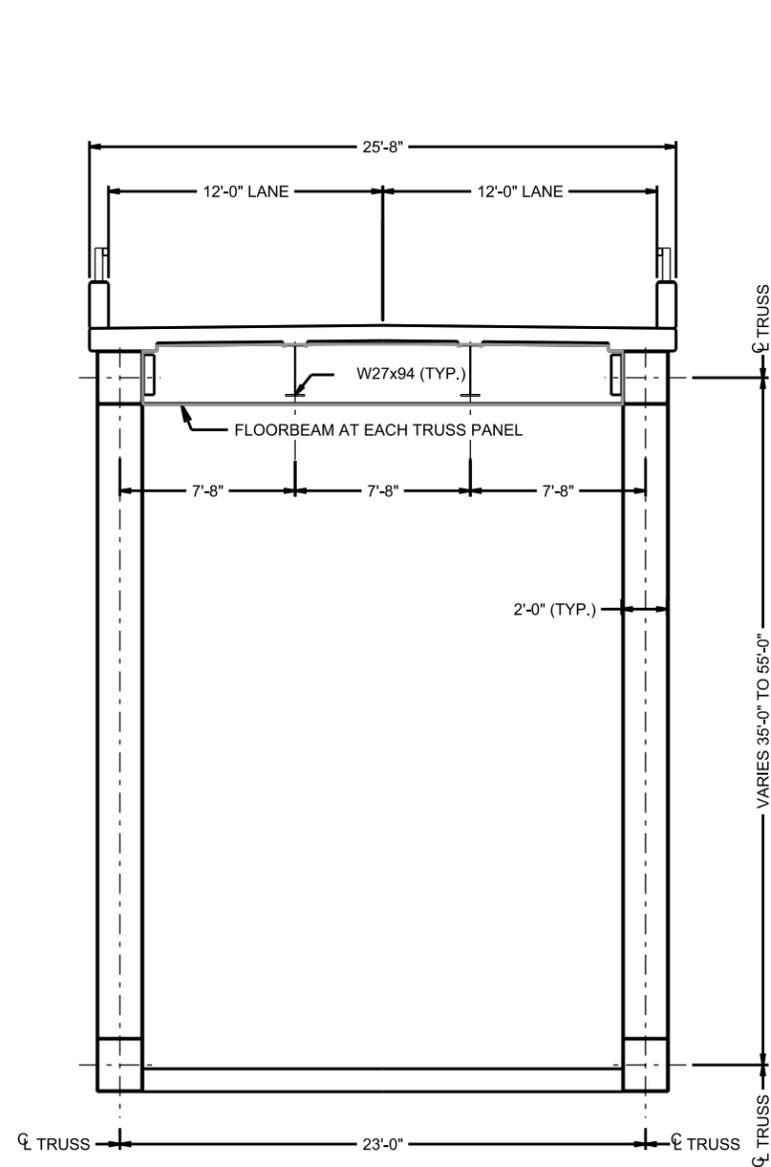
TYPICAL SECTION - DECK TRUSS APPROACH UNITS
