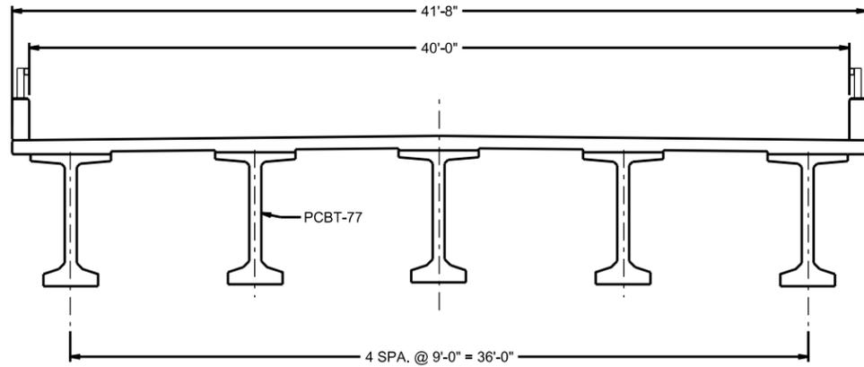
TYPICAL SECTION - BEAM & GIRDER UNITS
