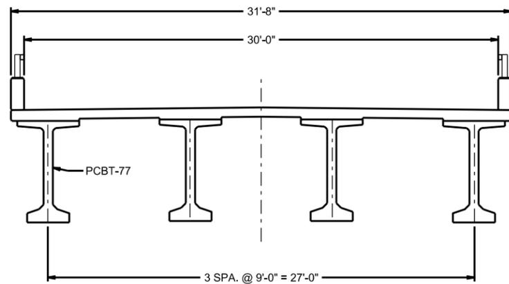
TYPICAL SECTION - BEAM & GIRDER UNITS
