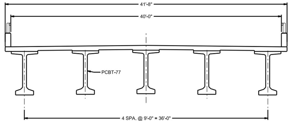
TYPICAL SECTION - BEAM & GIRDER UNITS
