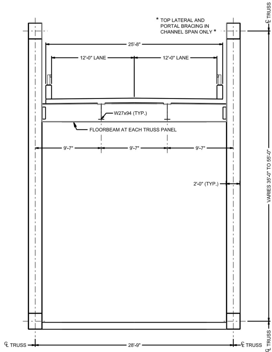
TYPICAL SECTION - THRU TRUSS CHANNEL UNIT
