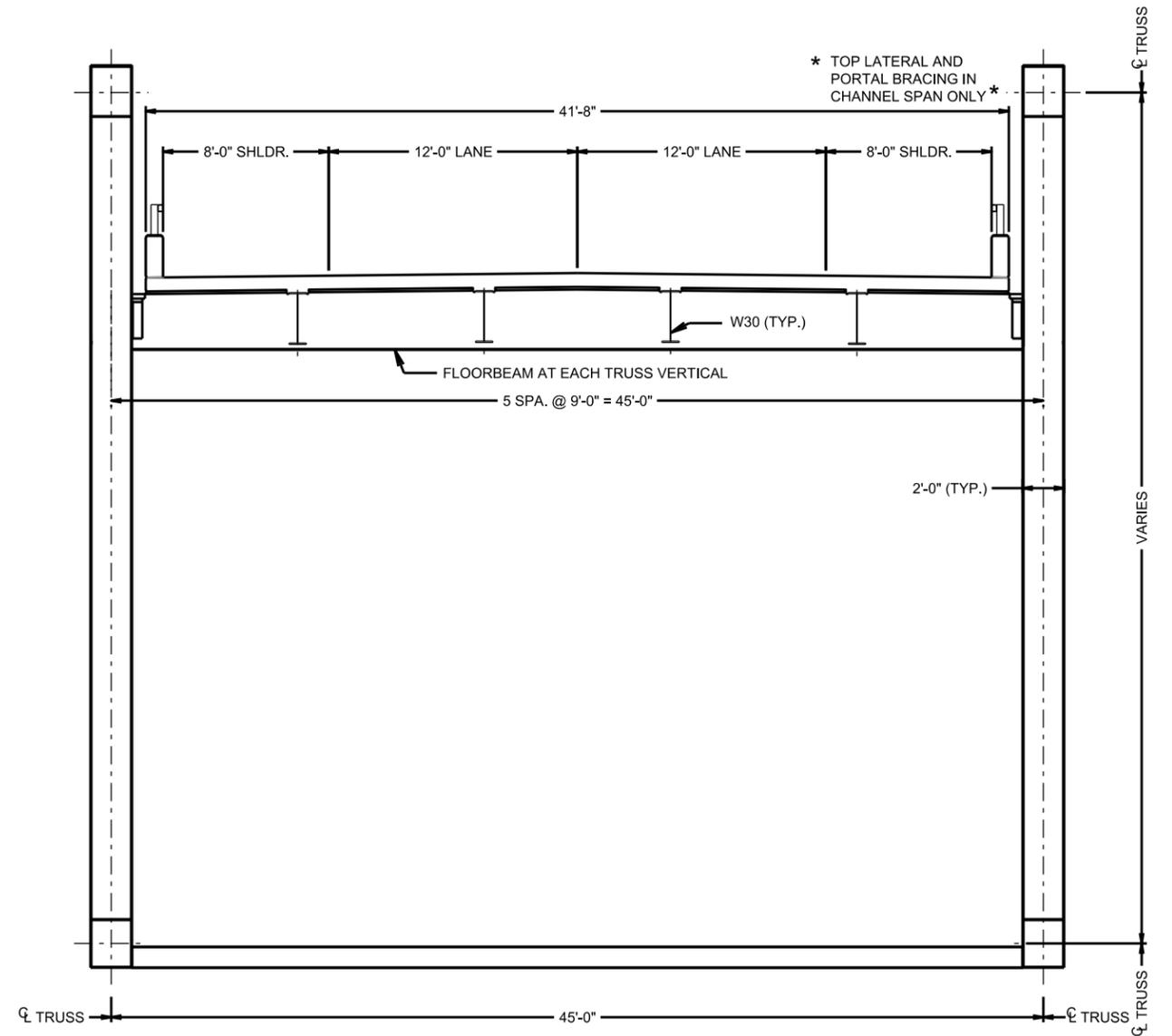
TYPICAL SECTION - THRU TRUSS CHANNEL UNIT
